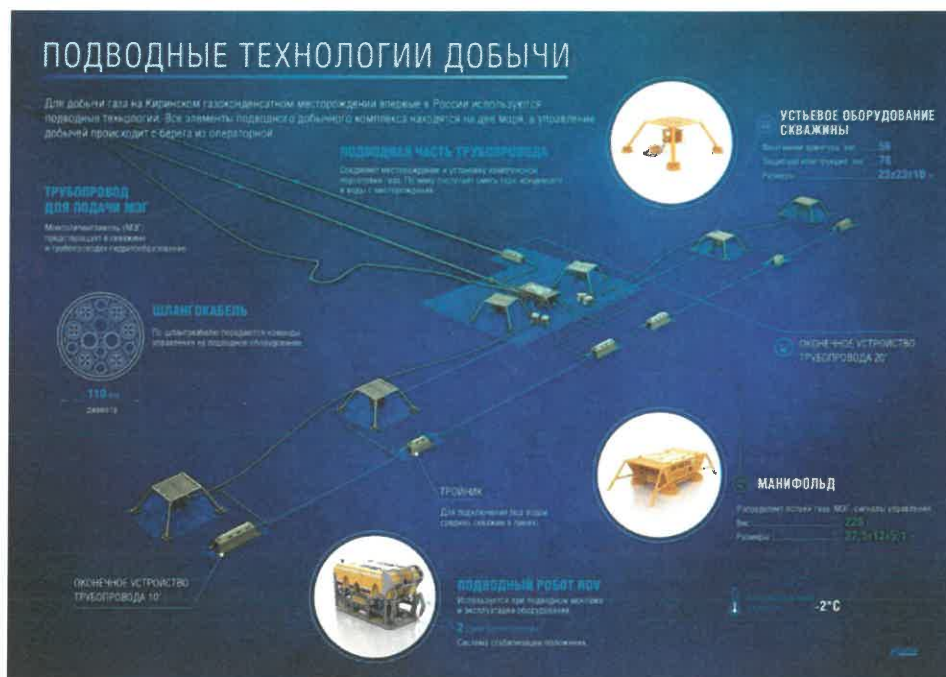
Рисунок 2.1 – Схема подводной технологии добычи Киринского ГКМ Устьевое оборудование скважины
